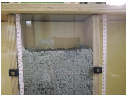
Figura 31. Prueba de asentamiento de celulosa de fabricación propia.
