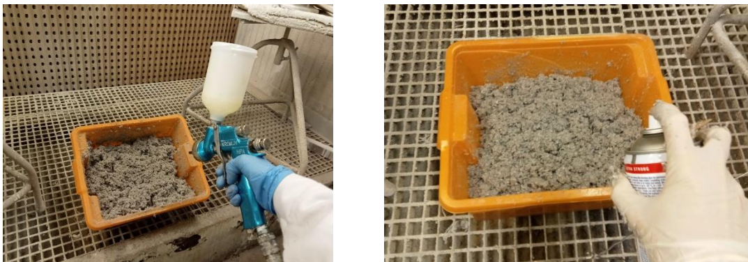
Figura 33. Aplicación del adhesivo ligante sobre las fibras de celulosa a pistola aerográfica (izquierda) y con spray (derecha)
