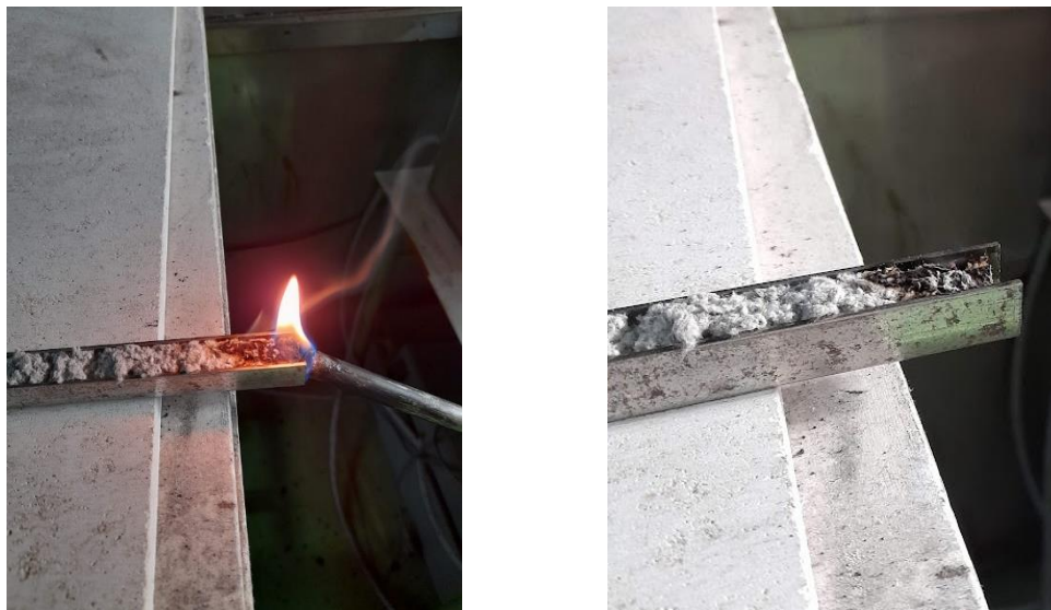
Figura 23. Ensayo adaptado. Aplicación de la llama (izquierda) y tras la finalización del ensayo
