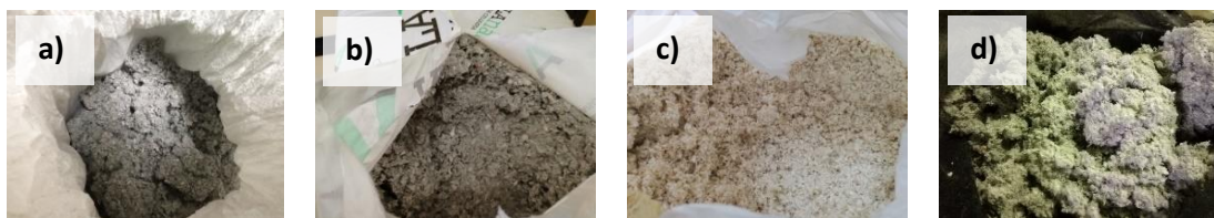
Figura 3. Material aislante de celulosa industrial pasada por máquina a), aislante celulosa sin por máquina b), aislante celulosa de papel blanco reciclado c), y aislante celulosa de fabricación propia d)
