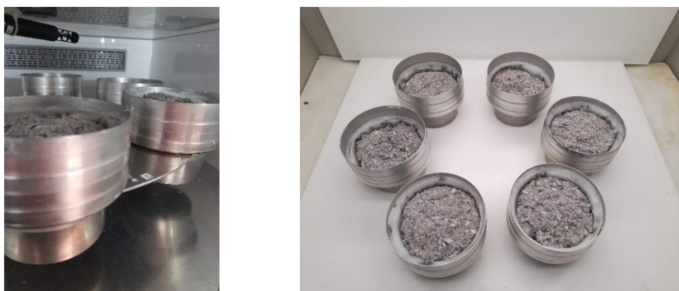
Figura 18. Detalle probetas y ensayo de permeabilidad al vapor de agua
