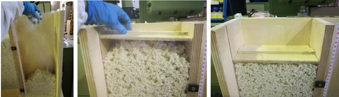
Figura 28. Relleno de cavidades del montaje y compactación de la celulosa.
