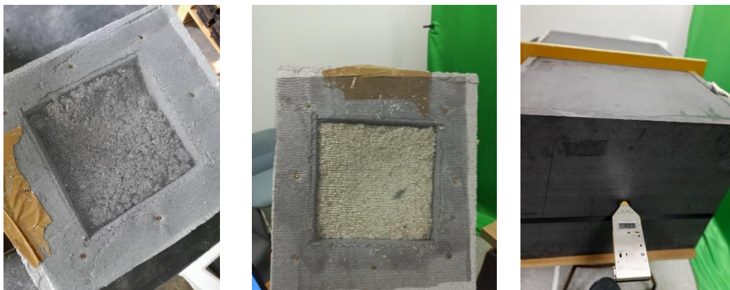
Figura 15. Detalle marcos para contener la celulosa y equipo de medida
