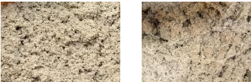
Figura 34. Detalle aplicación del adhesivo ligante sobre las fibras de celulosa pulverizado a pistola (izquierda) y con spray (derecha).
