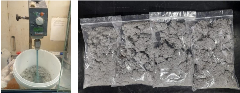
Figura 2. Proceso de mezclado y homogenización de la celulosa y aditivos.
