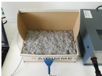
Celulosa industrial convencional pasada por máquina de insuflar
